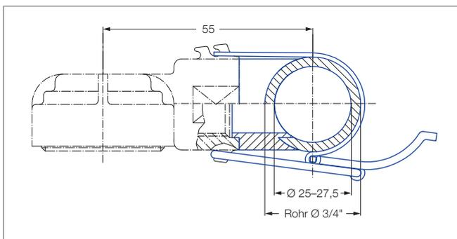
Empfohlener Bohrungsdurchmesser 18 mm.
